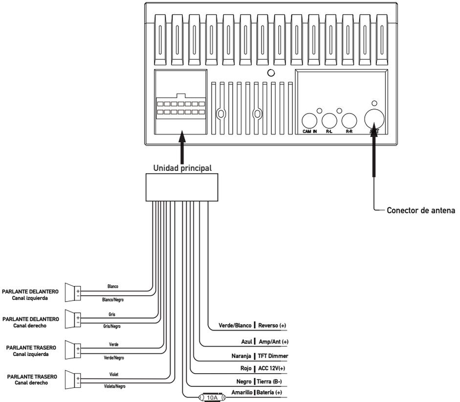
**Nota:** Cuando reemplace un fusible, asegúrese de usar el tipo y amperaje correcto. Usar un fusible incorrecto podría dañar la unidad. La unidad utiliza (1) fusible tipo mini ATC de 10 amperes que se encuentra en el conector de alimentación.
