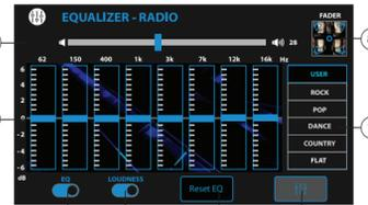
Los controles de frecuencia, atenuador y balance del subwoofer no tienen memoria de tono de fuente.
