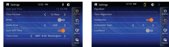
Sinc GPS Tiempo: Sincroniza el tiempo de reloj con el GPS. Manual: Dé vuelta apagado al GPS sincroniza y usted puede fijar la hora manualmente. Zona de tiempo: Seleccione la zona de tiempo.
