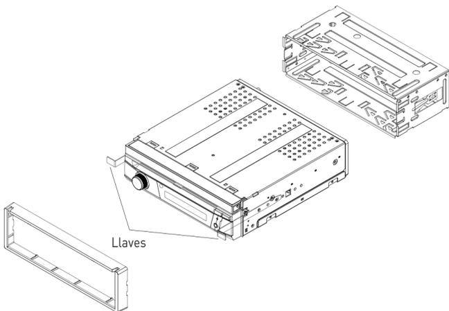
Método típico de montaje DIN de carga frontal
