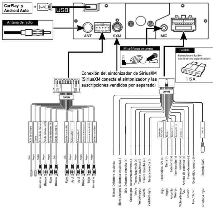
**Nota:** Cuando reemplace un fusible, asegúrese de usar el tipo y amperaje correcto. Usar un fusible incorrecto podría dañar la unidad. La unidad utiliza (1) fusible tipo mini ATC de 15 amperes que se encuentra en el conector de alimentación.
