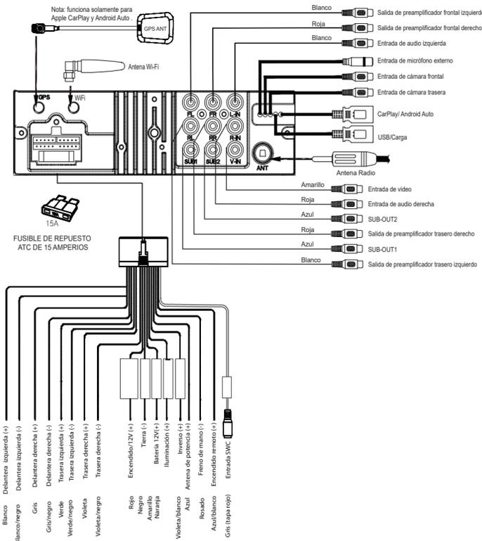
**Nota:** Cuando reemplace un fusible, asegúrese de usar el tipo y amperaje correcto. Usar un fusible incorrecto podría dañar la unidad. La unidad utiliza (1) fusible tipo mini ATC de 15 amperes que se encuentra en el conector de alimentación.
