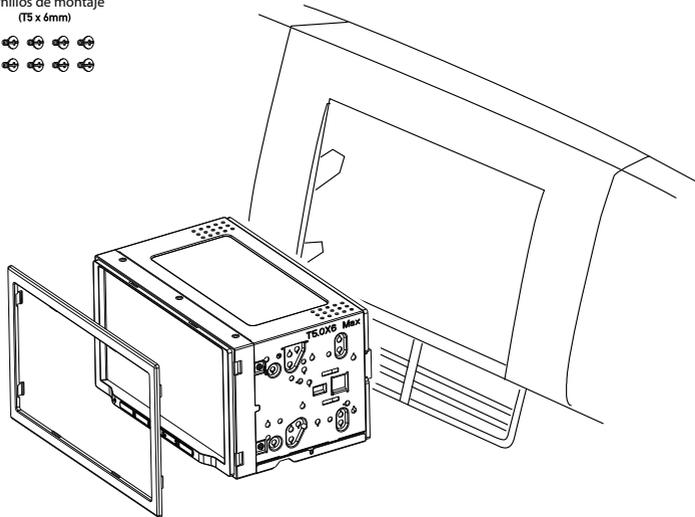
\* Utilice 2 o 3 tornillos para fijar el monitor al soporte.
